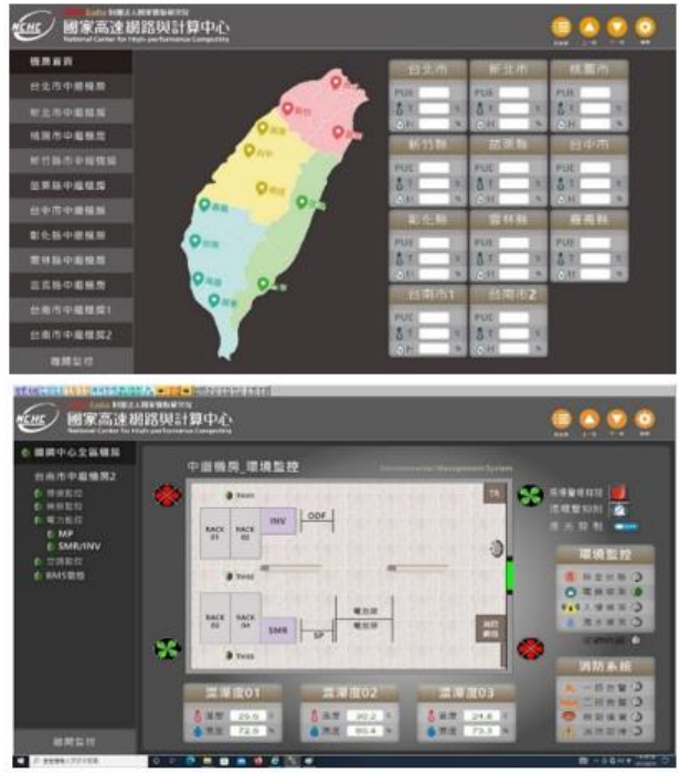
▲中繼機房環境遠端監控
